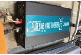
169 3000 Watt 12 Volt Pure Sine Wave Inverter
