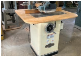
1 Shop Fox model #W1674 shaper 3/4" spindle 110/220 volt 1 phase
